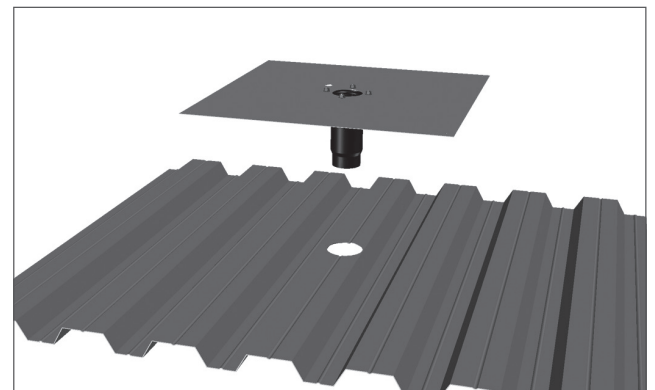
Abbildung 1.4: Verstärkungsblech mit Anschluss für Dampfdiffusionsbremse
